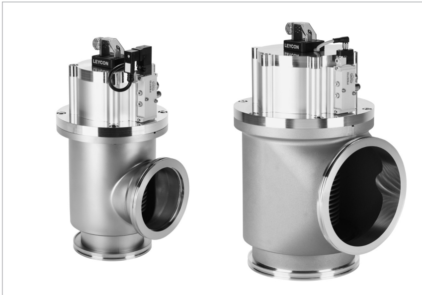
Eckventile mit Federbalg, elektropneumatischer Antrieb, Edelstahl, DN 100 ISO-K (links), Aluminium DN 160 ISO-K (rechts)
