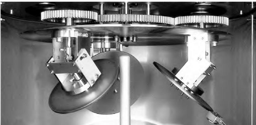
Planetenantrieb mit Zahnradgetriebe und drei Planeten, die fest montiert, aber winkleinstellbar sind
