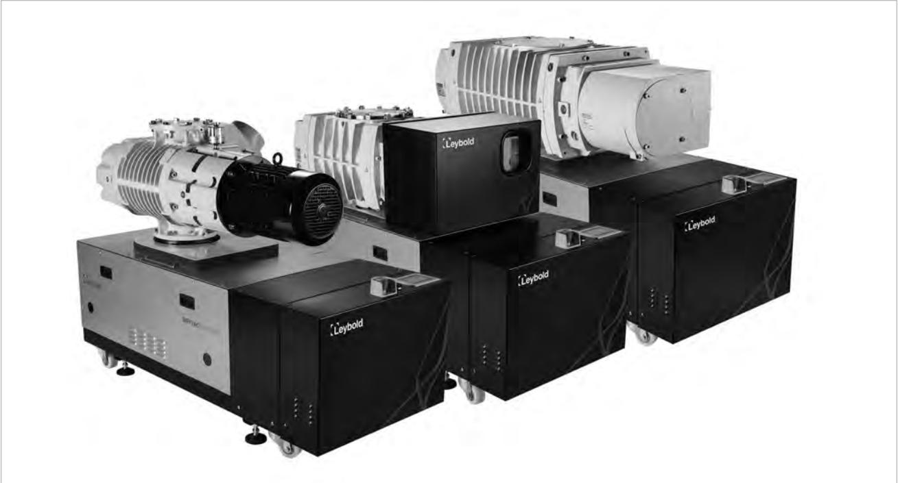
Die 2-stufigen DRYVAC-SYSTEME sind Kombinationen trockenverdichtender Wälzkolben- und Schraubenpumpen. Die auf der Vorvakuumpumpe montierte Wälzkolbenpumpe dient der Steigerung des Saugvermögens (Booster).
