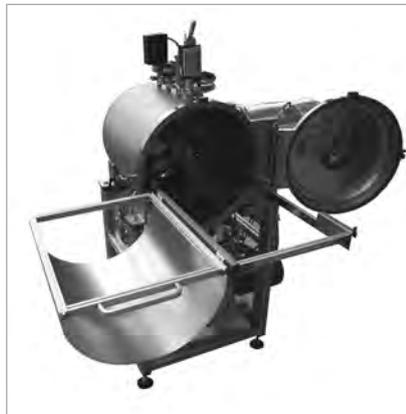
Geöffnete Beschichtungskammer mit herausgezogener Substrataufnahme
