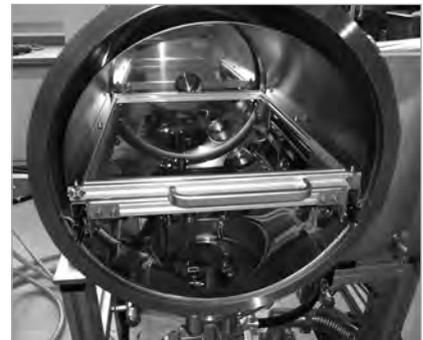
Blick in die Kammer mit thermischen Verdampfern und positionierter Substrataufnahmen
