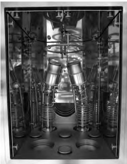
Zwei Magnetron-Sputterquellen, konfokal ausgerichtet auf den an der Kammerdecke rotierenden Substrathalter. Reserveflansche für zwei weitere Sputterquellen
