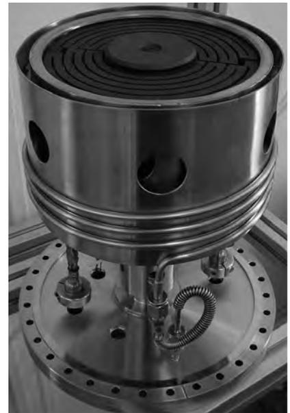
Rotierender Hochtemperatur-Strahlungsheizer mit SiC-Heizelement
