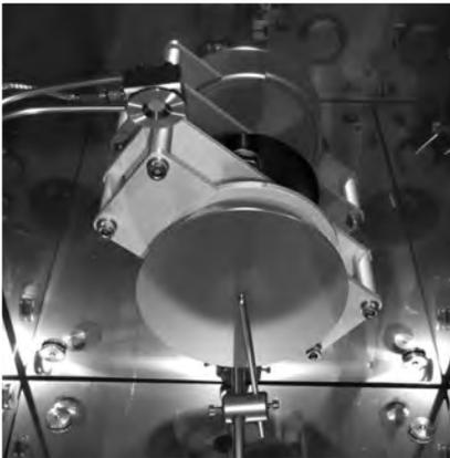
Motorischer Drehantrieb mit abnehmbarem Substrathalter (Bajonettverschluss).
