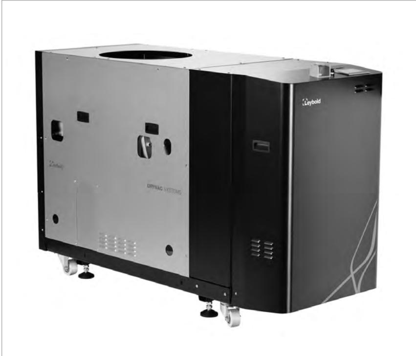
Das DRYVAC-SYSTEM 44HUF65S iv (DS 4465-U2) ist eine Kombination aus trockenverdichtender Schrauben- und Wälzkolbenpumpe. Es wurde speziell für das schnelle Auspumpen von Vakuumschleusen optimiert und verfügt über eine automatische Zykluserkennung sowie ein Drehzahlmanagement der Rootspumpe. Darüber hinaus wird der Geräuschpegel beim Abpumpen erheblich verringert, bei gleichzeitig optimaler Ausnutzung der Antriebsleistung.
