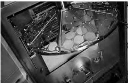
Kammerboden: Elektronenstrahl-Verdampfer, thermischer Verdampfer, Ionenquelle
