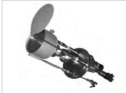
2"-Magnetron mit in-situ neigbarem Sputterkopf, pneumatischer Targetblende und Gaszuführung
