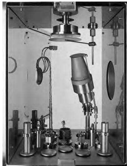
Blick durch die Vakuumkammer hindurch: frontseitige Schiebetür und rückseitige Drehtür geöffnet
