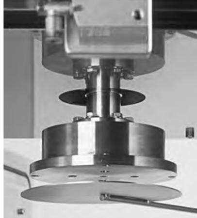
Dreh- und temperierbarer Substrathalter mit Substratblende
