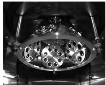
Planetenantrieb mit zentraler Reibscheibe und fünf freilaufenden Planeten
