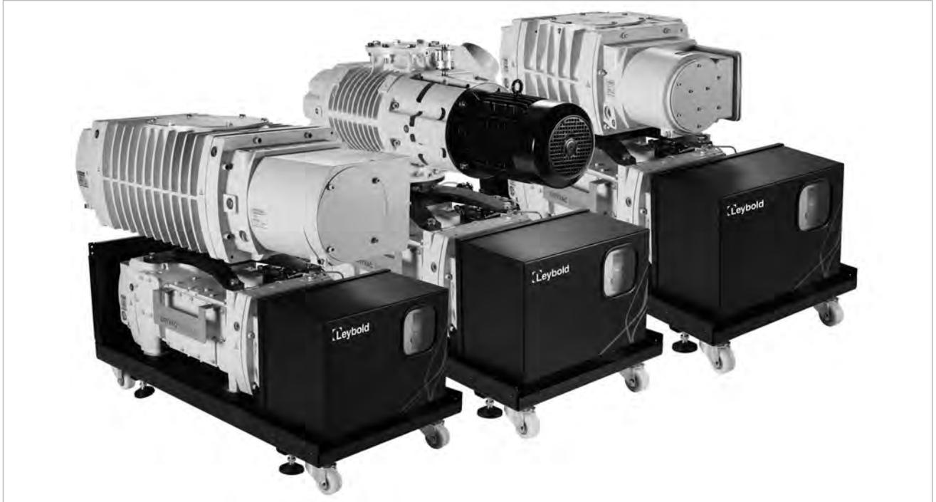
Die 2-stufigen DRYVAC-SYSTEME sind Kombinationen trockenverdichtender Wälzkolben- und Schraubepumpen. Die auf der Vorvakuumpumpe montierte RUVAC dient der Steigerung des Saugvermögens (Booster).
