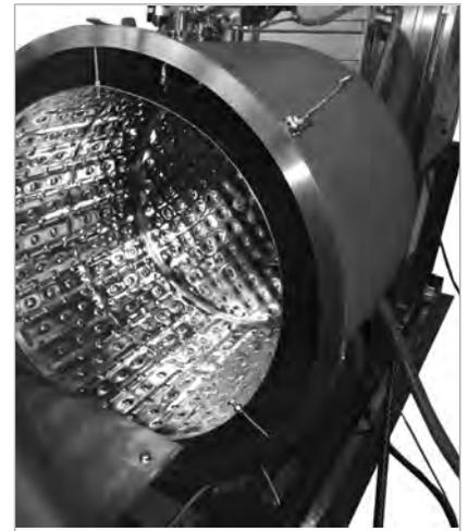
Geöffnete Kammer der UNIVEX 1000 S mit temperierbaren Shrouds und Substratablage
