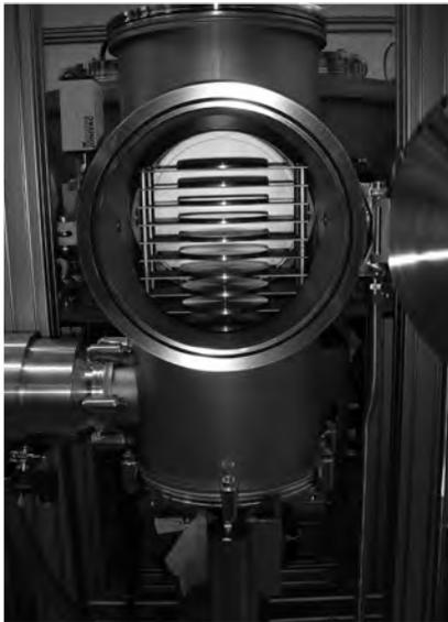
Manuell bedienbare Einschleuskammer mit Substrat-Magazin
