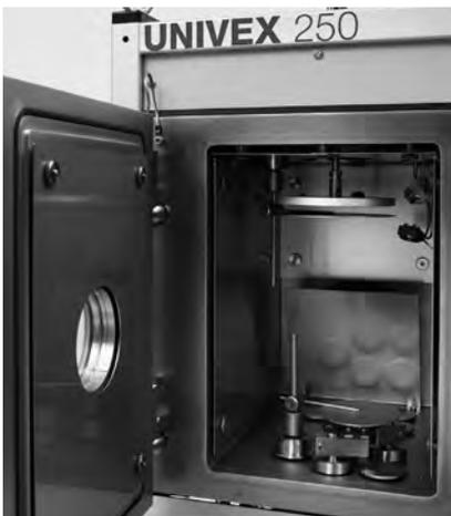
Kammerboden: thermischer Doppelverdampfer mit Quellenblende
