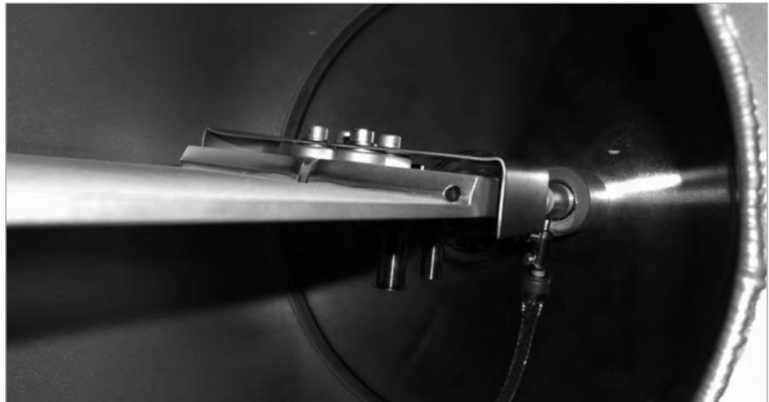
Isolierte Substratgabel mit RF-Bias-Anschluss
